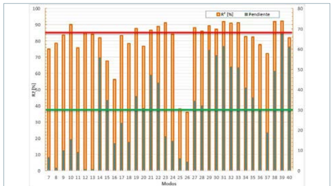
Figura 6. Diagrama de barras para R² y la pendiente p para la grieta circunferencial.
