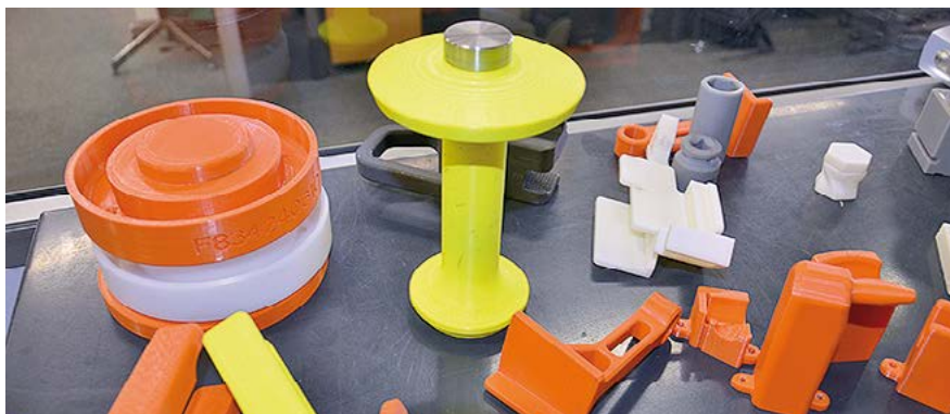
Con la tecnología de fabricación aditiva de Stratasy, Volvo Trucks ha reducido los plazos de fabricación de determinadas abrazaderas, plantillas y soportes de 36 a 2 días. Foto: Stratasy.
